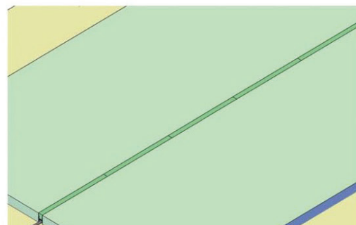
Nachdem alle Kontrollen abgeschlossen sind, werden die Beleuchtungs-bänder installiert und an ihren Plätzen befestigt.
