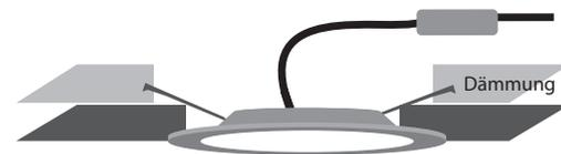
Achten Sie darauf, dass weder auf dem Treiber noch auf der Leuchte wärmedämmendes Material liegt.
