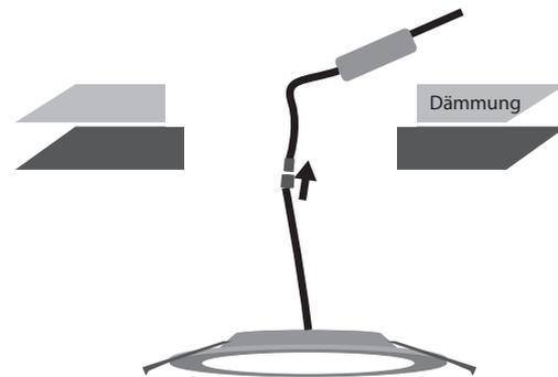
Schließen Sie den Treiber an die Stromleitung an.
