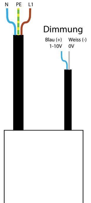
Wird keine Dimmung benötigt, stellen Sie sicher, dass die Dimmleitungen keinen Kontakt bekommen können. (In diesem Fall dimmt die Leuchte auf Minimum herunter)
