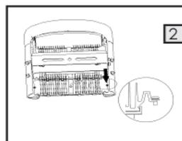
2. Lösen Sie die Schrauben an jedem Modul
