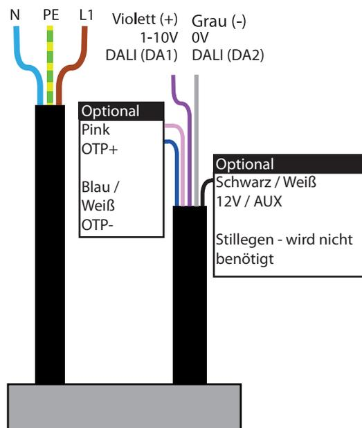
Wird keine Dimmung benötigt, stellen Sie sicher, dass die Dimmleitungen keinen Kontakt bekommen können. (In diesem Fall dimmt die Leuchte auf Minimum herunter)
