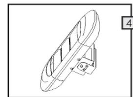
4. Verbinden Sie die Module mit den wasserdichten Verbindungen
