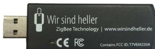
Um Treiberprobleme mit dem WSH ZigBee USB Dongle zu verhindern, sollten aktuelle Treiberzertifikate per Windowsupdate installiert sein.
