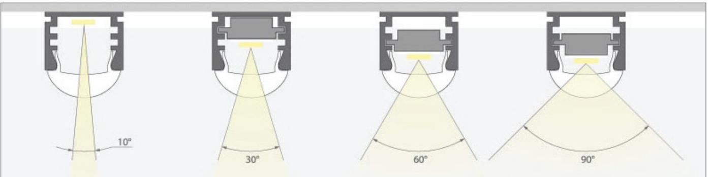
Dieses Profil ermöglicht verschiedene Abstrahlwinkel durch die Kombination von Linsenabdeckung und Aluminium.
