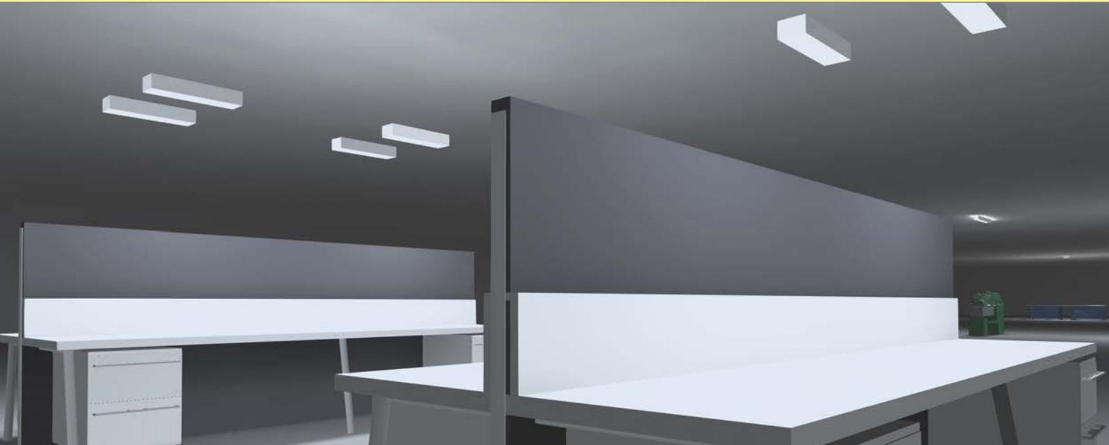
Gutes Licht am Arbeitsplatz erhöht die Produktivität und verringert die Fehlerquote. Ist die Arbeitsumgebung optimal ausgeleuchtet, können alle Arbeiten ohne Verschattung in gutem Licht ausgeführt werden. Um den Arbeitsplatz gezielt lichttechnisch zu gestalten, setzt man Arbeitsplatzleuchten ein, die direkt in der Arbeitsumgebung montiert werden und die Allgemeinbeleuchtung unterstützen.
