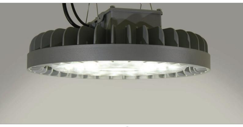
Der Treiber ist mit Wärmesensoren versehen, die den Strahler bei Überhitzung herunterdimmen. Das Wärmemanagement ermöglicht einen Einsatz bei einer Umgebungstemperatur von bis zu 65° C mit internem Treiber. Wird der Treiber extern verbaut kann der LED-Hallenstrahler sogar bei Umgebungstemperaturen von bis zu 75°C betrieben werden.
