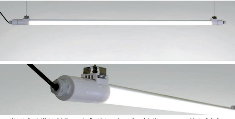
Die Lecko-E ist ein LED Linienlicht für anspruchsvollere Arbeitsumgebungen. Das einfache Montagesystem ermöglicht eine direkte Deckenmontage und eine Abpendelung. Das hochwertige Kunststoffgehäuse vermindert eine Schmutzanhaftung. Durch die hohe Schutzart von IP 67 ist die Lecko-E sowohl für Außen als auch Innenraumnutzung bestens geeignet. Eine hohe Lumenausbeute sorgt für eine homogene und kosteneffiziente Ausleuchtung.
